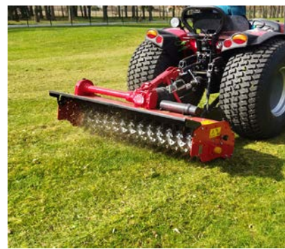
Le décompactage à aiguilles ou à lames
