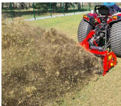
Le défeutrage en profondeur à couteaux
