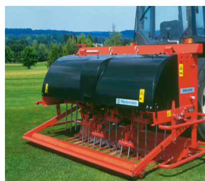
Le décompactage à aiguilles ou à lames
