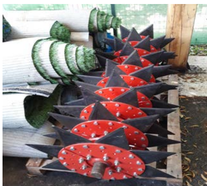
Le défeutrage en profondeur à couteaux
